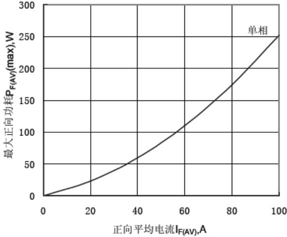
Fig.3 最大正向功耗与平均电流关系曲线
