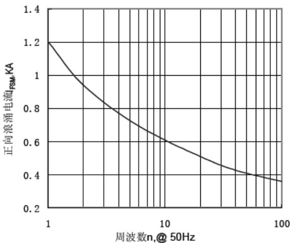
Fig.5 正向浪涌电流与周波数的关系曲线
