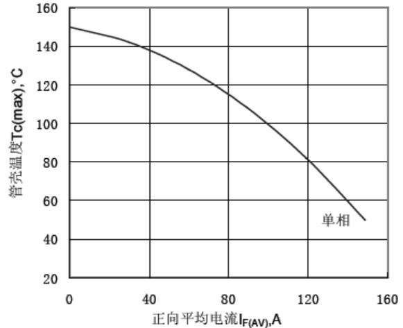
Fig.4 管壳温度与平均电流关系曲线
